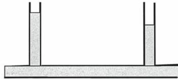
5. Sur la canalisation horizontale on place deux tubes verticaux remplis d'eau séparés de 10 m. On mesure une différence de hauteur de 2 cm entre ces deux tubes.
